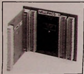
Een 2 mm interconnectiesysteem voor de Futurebus+.
