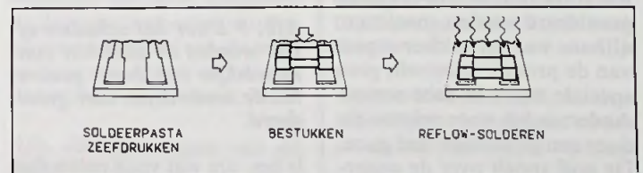
Afb. 6 De drie produktiestappen bij het reflowen van SMD-printen.
