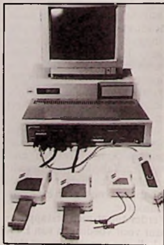
Een 64/128 kanaals data acquisitiesysteem met ingebouwde PC.
