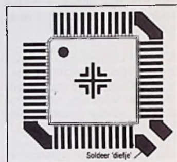
Afb. 13 Plaats van de soldeerdiefjes bij PLCC-IC's.
