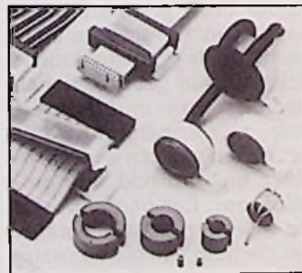
Ferrieten voor het ontstoren van onder andere bandkabel.
